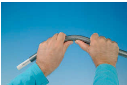
Zginanie za pomocą zewnętrznej sprężyny spiralnej.
