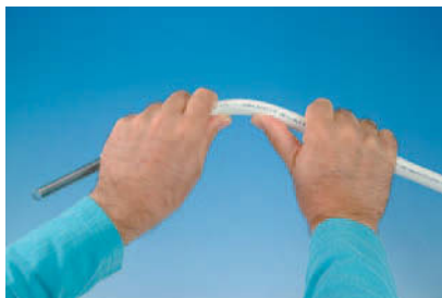
Zginanie za pomocą wewnętrznej sprężyny spiralnej.
